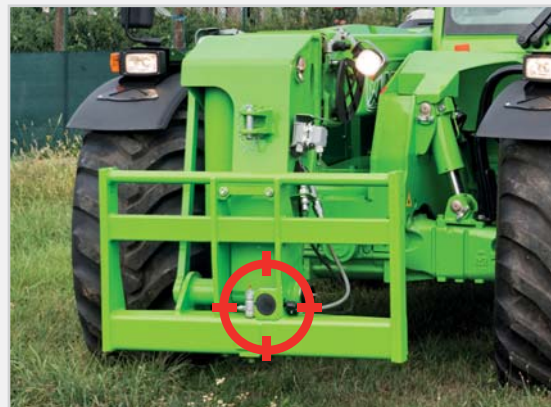
Am Anbaurahmen angebrachter Sensor
