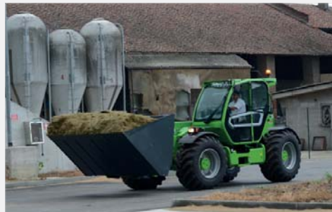
Vom Bediener aktivierbare hydropneumatische Schwingungsdämpfung des Hubzylinders „BSS“ (Sonderausstattung) Bei einer Geschwindigkeit unter 3 km/h wird sie automatisch deaktiviert, um große Präzision beim Laden der Lasten zu garantieren.
