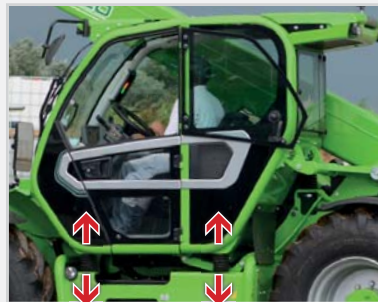
Vom Bediener aktivierbare hydropneumatische Schwingungsdämpfung der Kabine
