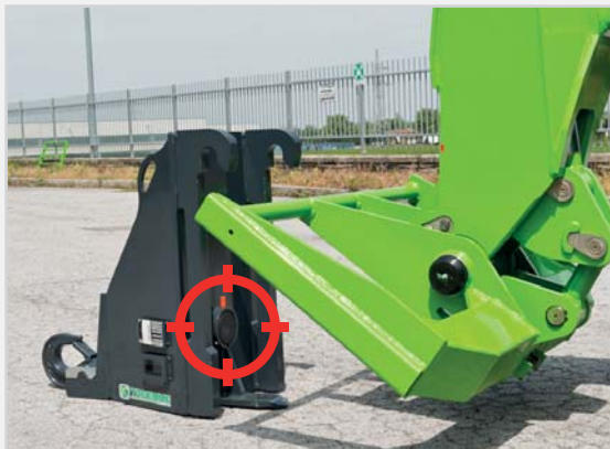
Am Werkzeug angebrachter Sensor
