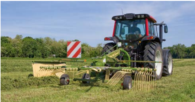
Einkreiselschwader Swadro, angebaut Arbeitsbreiten von 3,50 m bis 4,60 m
