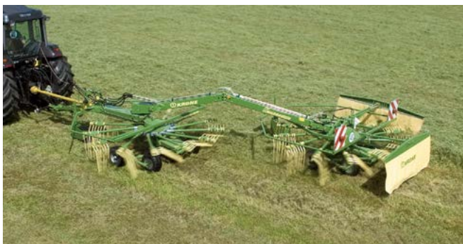
Zweikreisel-Seitenschwader Swadro 710/26T Arbeitsbreite 6,20 m oder 2 x 3,40 m
