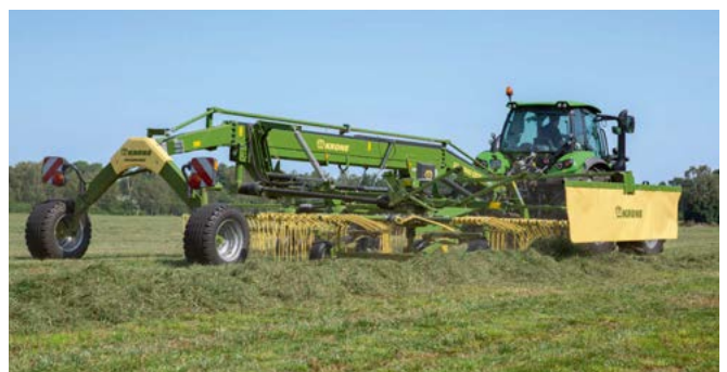
Dreikreisel-Seitenschwader Swadro TS 970 Arbeitsbreite 9,70 m
