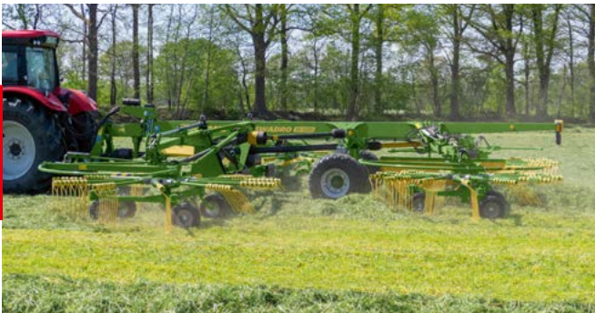
Vierkreisel-Mittelschwader Swadro TC 1250 Variable Arbeitsbreiten von 9,80 m bis 12,50 m
