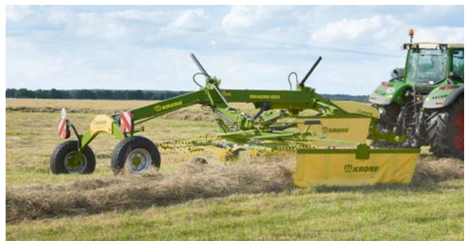
Zweikreisel-Seitenschwader Swadro TS und TS Twin Arbeitsbreiten von 6,20 m bis 8,20 m
