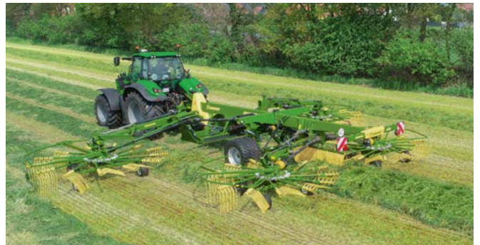
Vierkreisel-Mittelschwader Swadro TC 1370 Variable Arbeitsbreiten von 10,80 m bis 13,70 m
