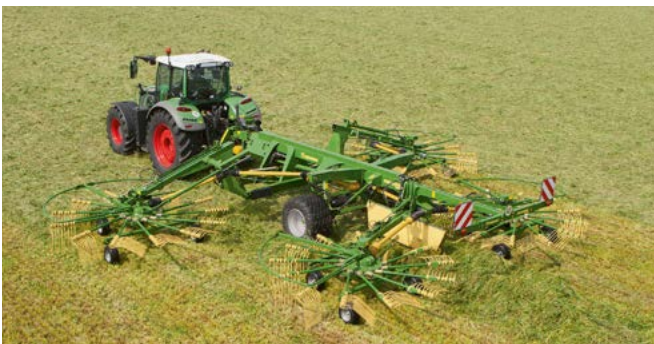
Vierkreisel-Mittelschwader Swadro 1400 und 1400 Plus Variable Arbeitsbreiten von 11,00 m bis 13,50 m
