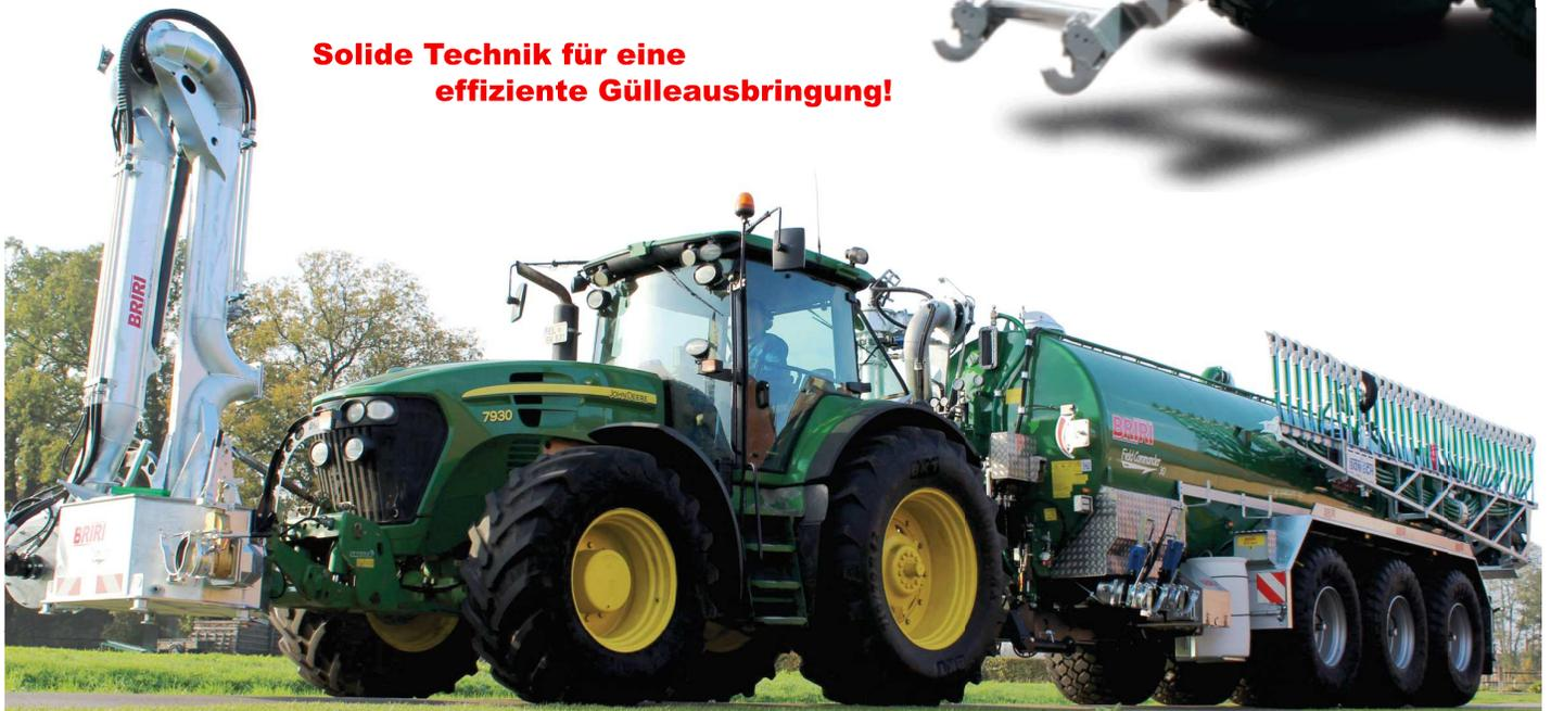
Der **Field Chief** verfügt über ein Volumen von 12 m<sup>3</sup> bis 16 m<sup>3</sup> und wird von einer massiven 30 t Achse getragen. Zwei Fasseinschnitte sorgen für einen tiefen Schwerpunkt. Das kompakte und wendige Fahrzeug bildet eine echte Alternative zu einem Selbstfahrer.
