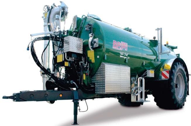
Der **Field Master** ist mit einem Tandemfahrwerk ausgestattet und besitzt ein größeres Behältervolumen. Dieses startet bei 12 m<sup>3</sup> und geht bis 20 m<sup>3</sup>. Ein luftgefedertes oder hydropneumatisches Achsaggregat sorgt für den nötigen Fahrkomfort. Eine elektrohydraulische Zwangslenkung gehört dem Serienumfang an.
