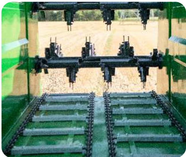
Der hydraulisch angetriebene Kratzboden ist reversierbar und besteht aus massiven U-Profilen, die versetzt auf zwei Bahnen angeordnet sind. Dieses reduziert den Schlupf auf ein Minimum. Die hochfesten 14 mm Transportketten weisen eine Bruchlast von je 21 t auf. Offene Nusskettenräder sorgen für eine gute Selbstreinigung und verhindern so ein Übersetzen der Ketten. Die federbelasteten Kettenspanner sorgen für einen ausreichend gespannten Kratzboden.
