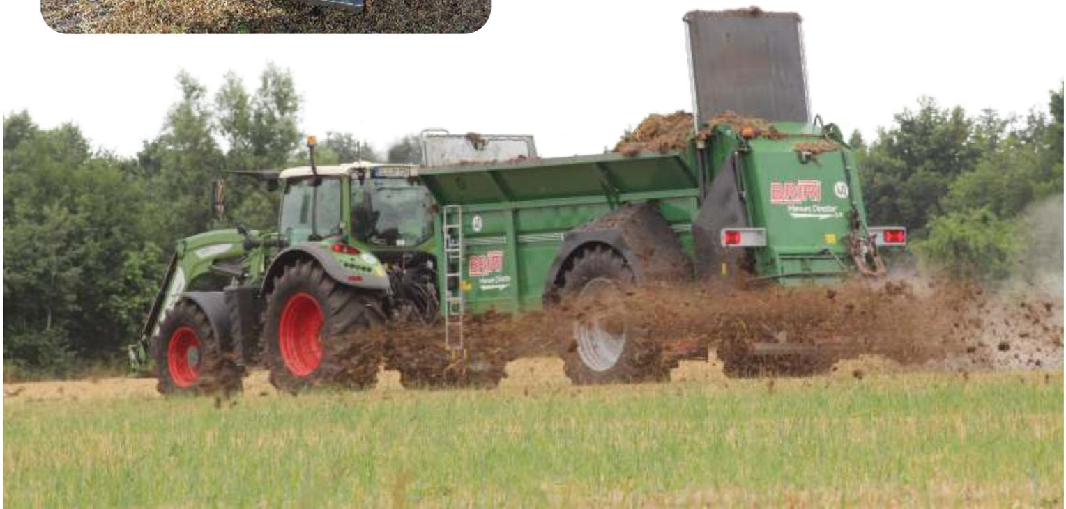
Das Fahrwerk besticht durch die massive ADR-Achse, die für Traglasten von bis zu 30 to ausgelegt ist. Abgebremst wird das Fahrzeug über eine Druckluftbremsanlage. Die Bremsen der Größe 520 x 180 samt Tristopzylinder sorgt nicht nur für ein sicheres Abbremsen, sondern erspart zudem das Anziehen der Handbremse bei abgestelltem Fahrzeug.
