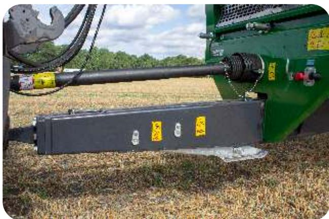
Ausgestattet ist der Streuer mit einer Deichsel zur Untenanhängung in K80. So kann die serienmäßig gefederte Einholmdeichsel Stützlasten von bis zu 4 to übertragen. Durch die schlanke Bauform wird ein maximaler Einschlagwinkel sichergestellt. Der mittig angeordnete Stützfuß gewährleistet einen sicheren Stand. Im angekoppelten Zustand der Maschine hebt sich der Stützfuß hydraulisch in die Deichsel und sorgt somit für keinerlei Behinderungen während des Feldeinsatzes.
