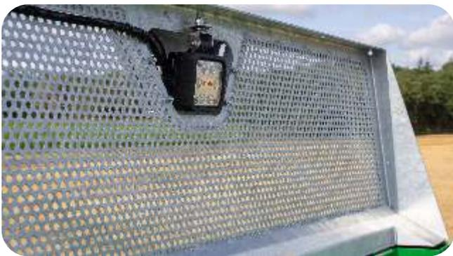
Serienmäßig verfügt der Streuer über eine LED Beleuchtung nach StVZO, kann aber um eine Vielzahl an weiteren Leuchteinrichtungen ergänzt werden. Beispielsweise um Seitenmarkierungsleuchten oder um eine Rundumleuchte.
