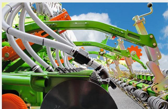
Sensor zur Erfassung des Saatgutstroms am Säschar
