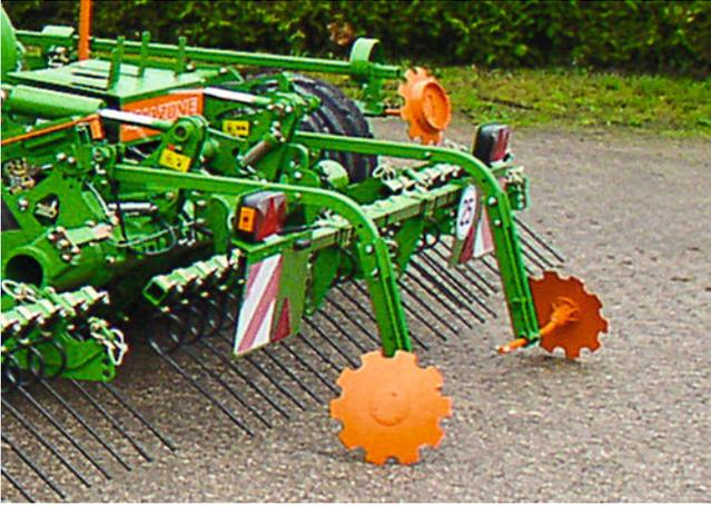
Fahrgassenmarkierung und Heckstriegel
