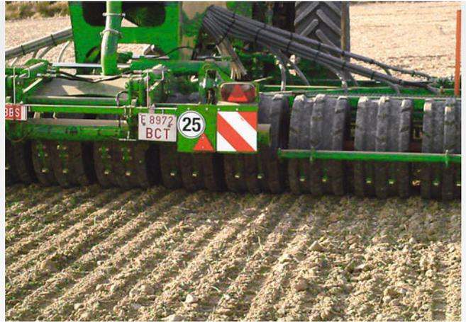
Keilringwalze mit Matrixreifenprofil
