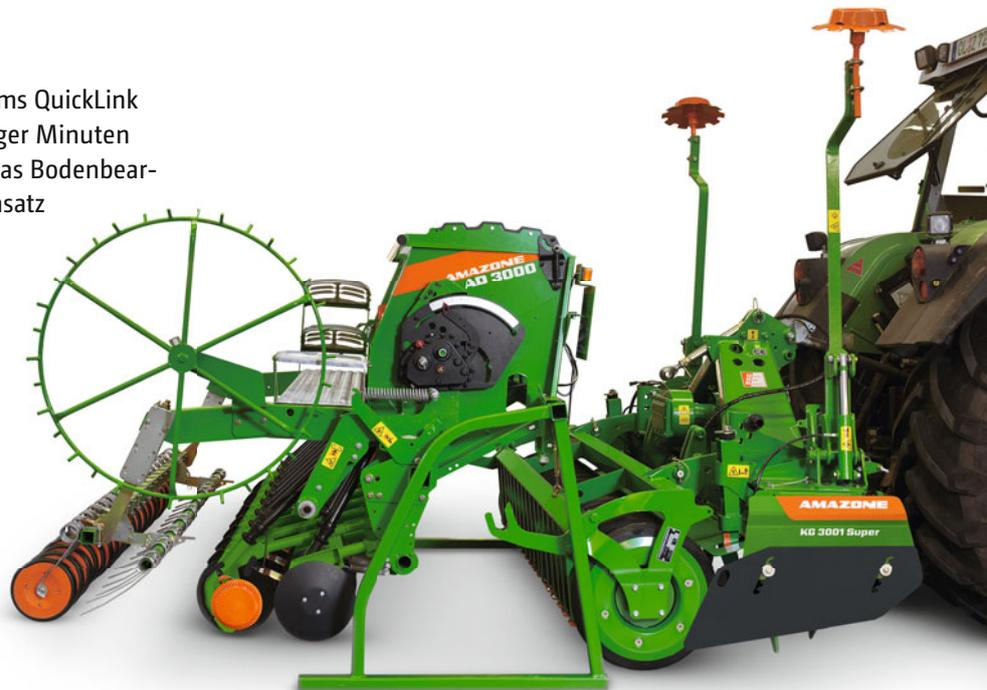
Drei gut zugängliche Kupplungspunkte des Schnellkuppelsystems QuickLink sorgen für einen sicheren, werkzeuglosen und schnellen An- und Abkuppelvorgang
