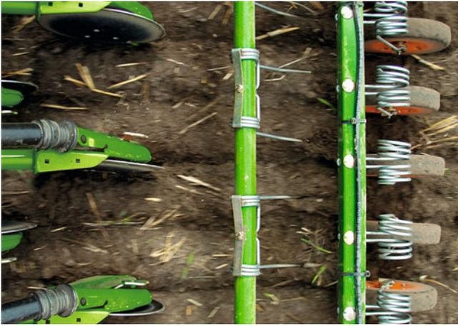
Der große Abstand zwischen der hinteren und vorderen Scharreihe sichert eine verstopfungsfreie Saat auch bei großen Strohmenngen.
