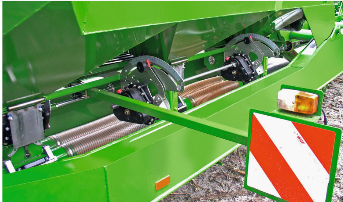
Das Vario-Getriebe ermöglicht Aussaatmengen von 2 bis 400 kg.
