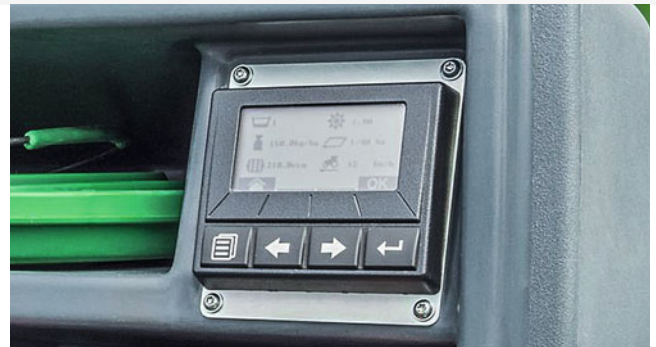
Kalibrieren über das TwinTerminal 3.0
