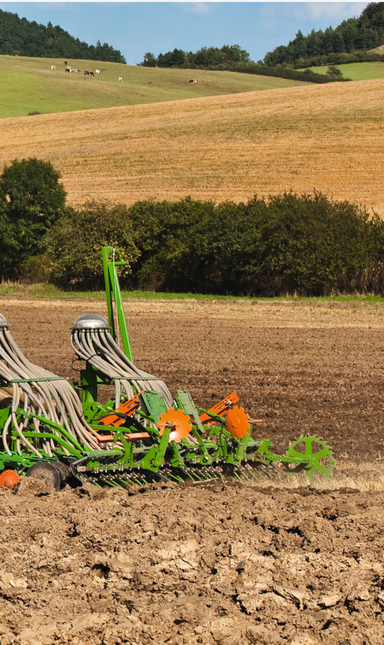
Fronttanksäkombination Avant, 6 m Arbeitsbreite
