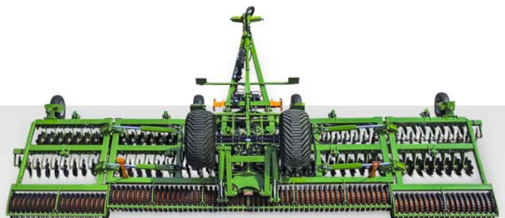
Catros+ 12003-2TS mit 12 m Arbeitsbreite
