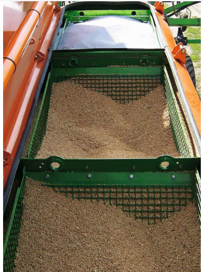
✔ 3-Kammerdruckbehälter bei der Citan 12001-C und 15001-C
