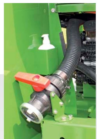
Befüllung über Druck (C- oder Kamlok-Kupplung)
