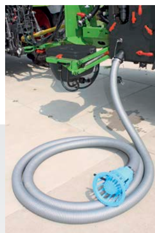
Befüllung über Saugschlauch
