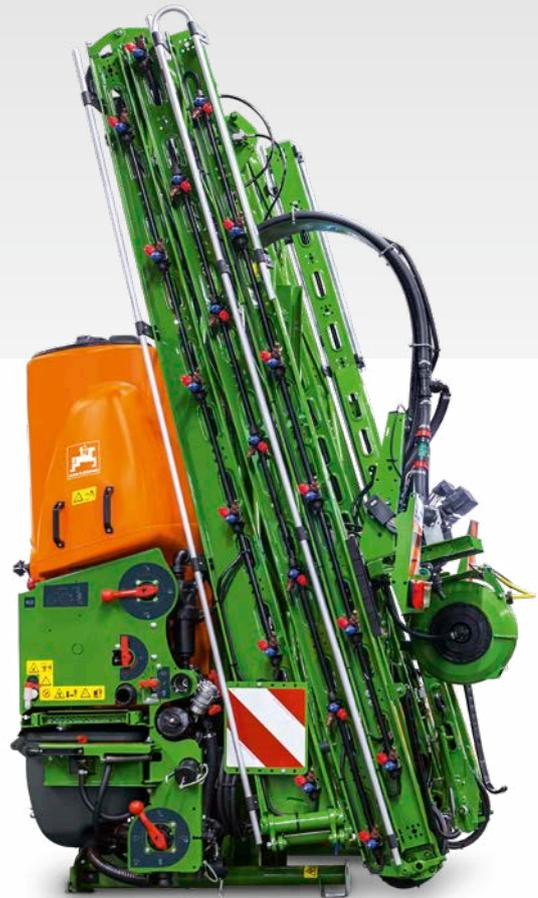
❗ „Die Transportbreite bleibt bei 2,40 m – ein großer Vorteil der Paketklappung nach oben.“
