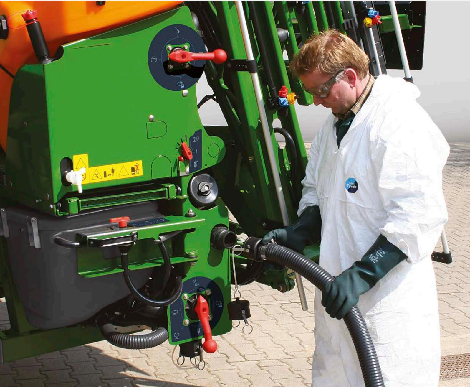
✔ **Befüllung mit dem Saugschlauch**
