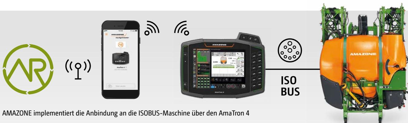
AMAZONE implementiert die Anbindung an die ISOBUS-Maschine über den AmaTron 4
