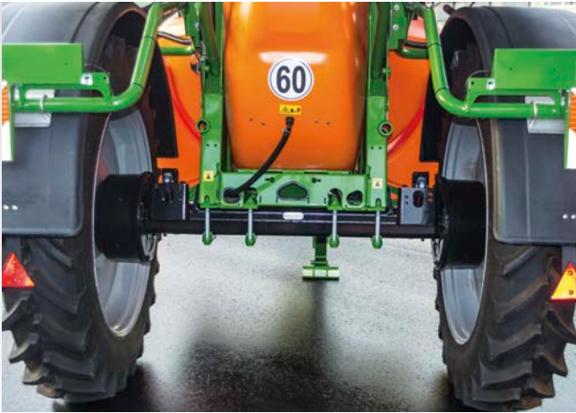
Festachse mit Spurweiten von 1,50 m bis 2,25 m
