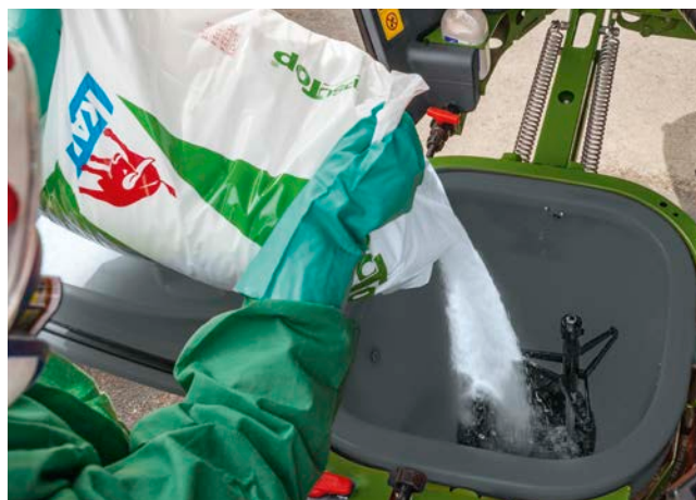
Der leistungsfähige 60-l-Einspülbehälter
