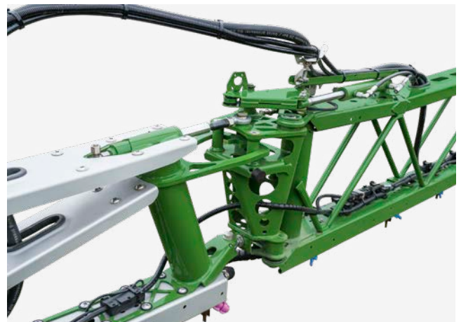
Hydraulisch vorgespanntes Ausweichgelenk am Endausleger mit dem Saloon-Tür-Prinzip
