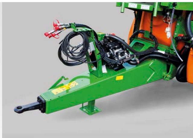
Untenanhangung mit Zugöse und mechanischem Stützfuß
