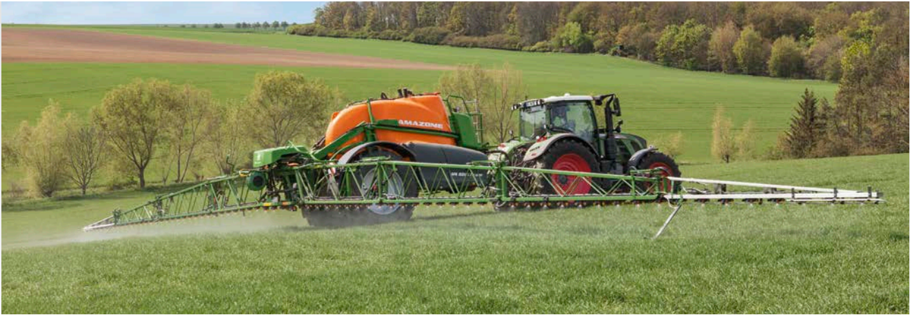
ContourControl mit Gestängeanwinkelung nach unten
