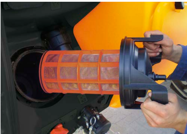
Der Saugfilter kann bei voller Maschine ohne Spritzflüssigkeitsverlust geöffnet und gereinigt werden.
