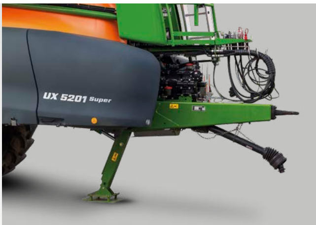
Obenanhangung mit Zugöse und hydraulischem Stützfuß
