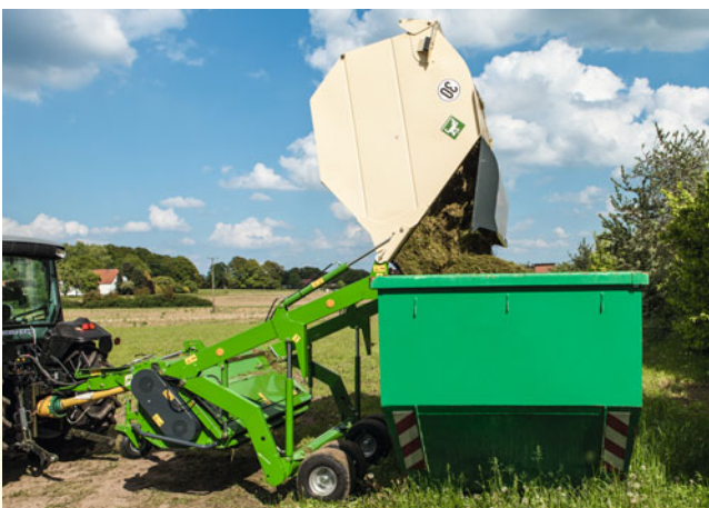
Mit bis zu 2,3 m wird das Entleeren des Behälters auch auf höheren Anhängern oder in größere Container möglich
