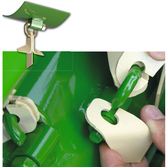
Werkzeugloser Umbau auf Vertikutieren – schnell gemacht
