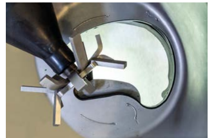
Stufe 3: Trichteröffnung weit geöffnet
