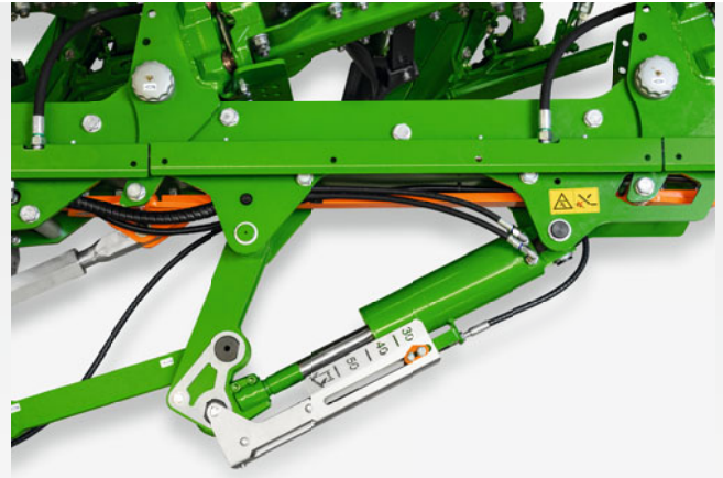
Hydraulische Einstellung der Arbeitsbreite
