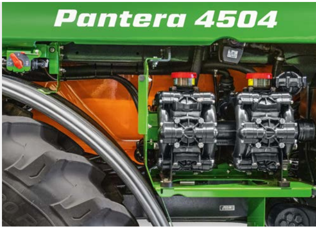
Pumpenanlage auf der rechten Maschinenseite
