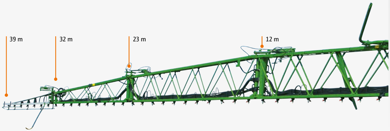
39-m-Super-L2-Gestänge, reduzierbar auf 32 m, 23 m und 12 m
