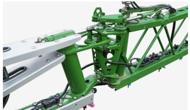
Die hydraulisch vorgespannte Überlastsicherung des Endauslegers (mit Saloon-Tür Prinzip) kann nach hinten, vorne und oben ausweichen und sorgt für ein zuverlässiges Zurückschwenken und eine lange Lebensdauer.
