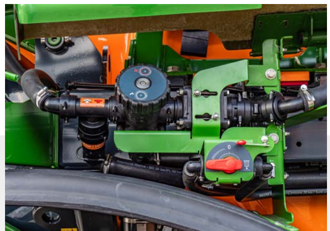
✓ HighFlow + ist mit einem zusätzlichen, selbstreinigenden Druckfilter ausgestattet
