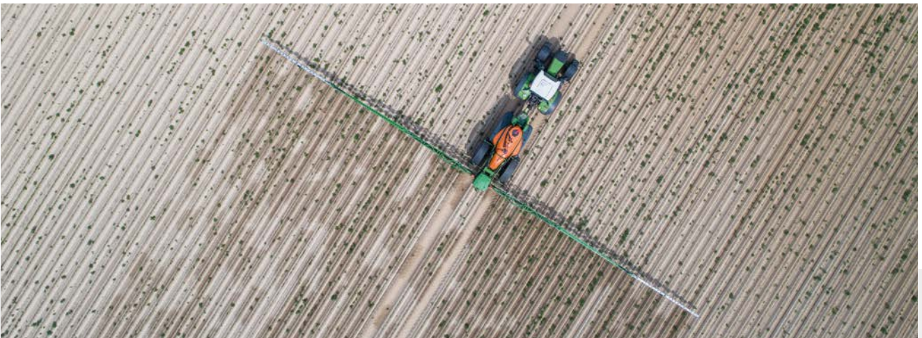
Modernste Pflanzenschutztechnik im Einsatz: Gezielte Behandlung von Durchwuchskartoffeln in einem Möhrenbestand auf Basis einer Spot-Applikationskarte mit einer serienmäßigen Anhängespritze UX 5201 Super
