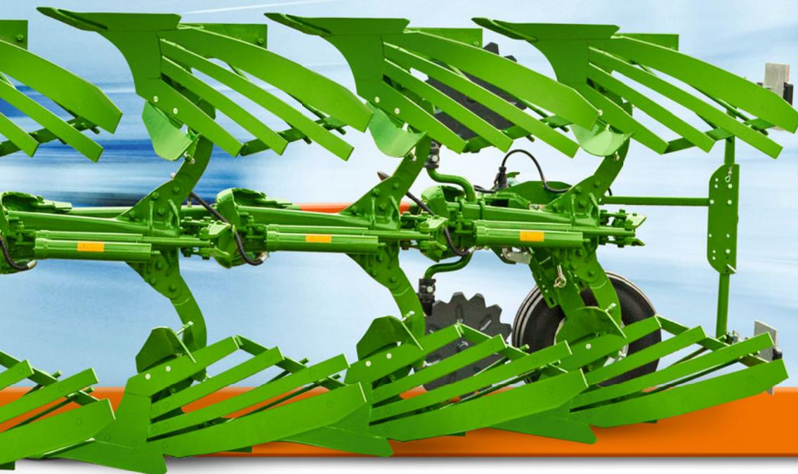
Die Anbau-Volldrehpflüge Cayros M, XM, XMS, XS und XS pro gibt es vom 2-Schar- bis 6-Scharpflug für Traktoren von 50 bis 380 PS. Alle Cayros-Pflüge verfügen serienmäßig über eine Steinsicherung mit Scherbolzen und eine mechanische Arbeitsbreitenverstellung in vier Stufen. Als Sonderausstattung ist der Cayros S mit vollautomatischer hydraulischer Steinsicherung und der Cayros V mit hydraulischer Arbeitsbreitenverstellung erhältlich.
