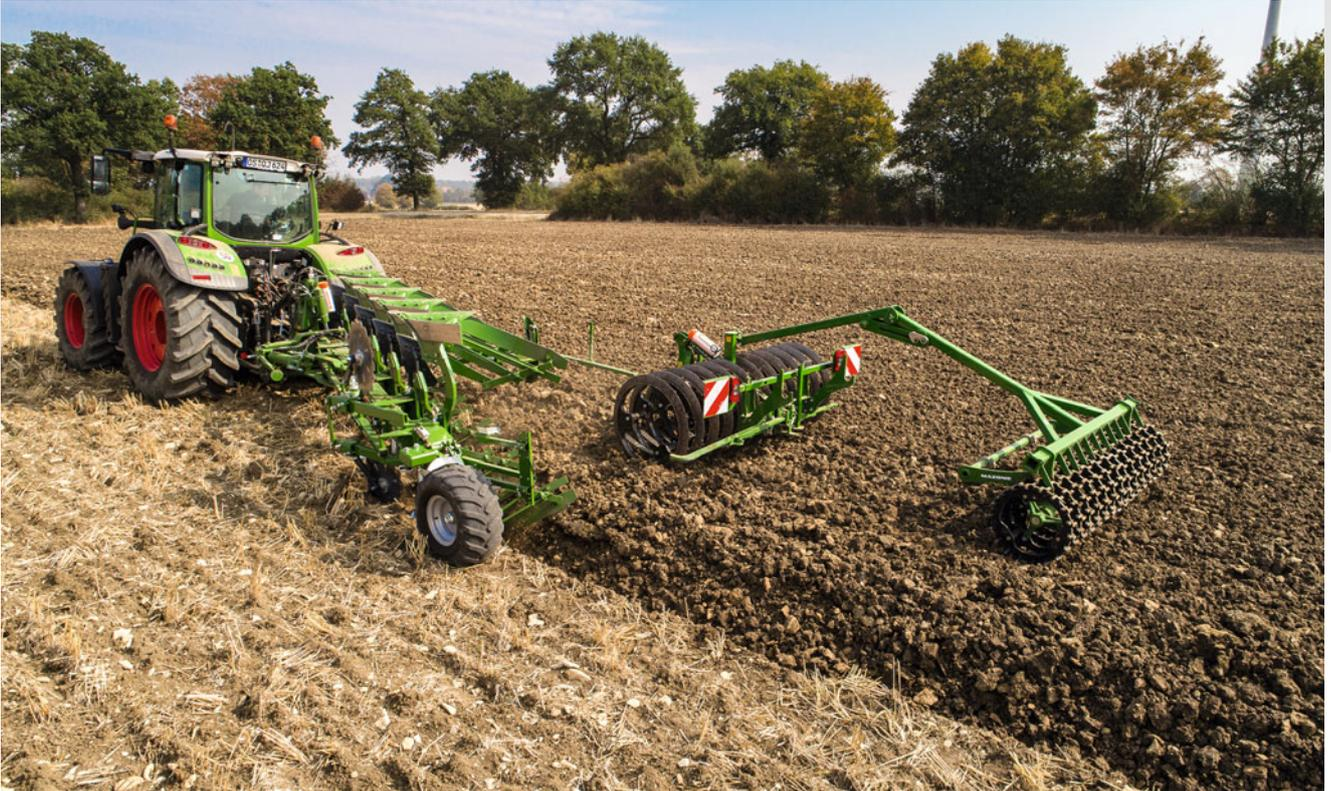
Für den kombinierten Einsatz mit Pflug-Wendepackern sind alle Cayros-Pflüge mit einem hydraulisch entriegelbaren Packerarm ausrüstbar. Dank einer direkten Kuppelung an die Wendehydraulik des Anbaupflugs wird kein zusätzliches Steuergerät benötigt.
