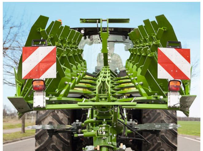
Die Beleuchtung ist leicht demontierbar und kann für die Feldarbeit schnell und einfach entfernt werden
