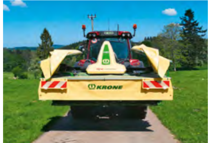
Die Arbeitsstellung mit 4 Meter (links) und die Stellung für die Strassenfahrt mit 3 Meter Breite.
